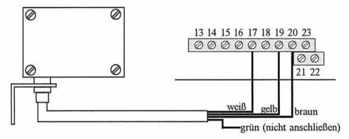
Der DCF-Empfänger wird standardmäßig mit 10 m Kabel geliefert und kann im Innen- oder im Außenbereich installiert werden. Wenn ein längeres Kabel benötigt wird, ist ein abgeschirmtes, dreiadriges Kabel zu verwenden. Gesamtlänge maximal 300 m.
