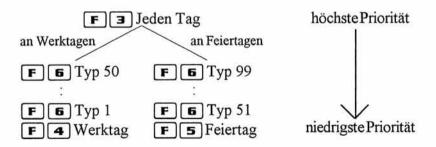
Es ist möglich, diese Tagesprogramme nur für einen Teil der Signalstromkreise zu definieren, sodaß für die Schaltfunktionen der restlichen Signalstromkreise das normale Tagesprogramm (F4 bzw. F5) ausgeführt wird.
