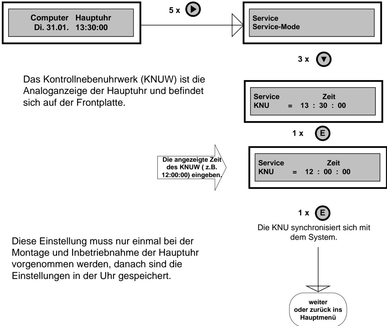
Das Kontrollnebenuhrwerk (KNUW) ist die Analoganzeige der Hauptuhr und befindet sich auf der Frontplatte.
