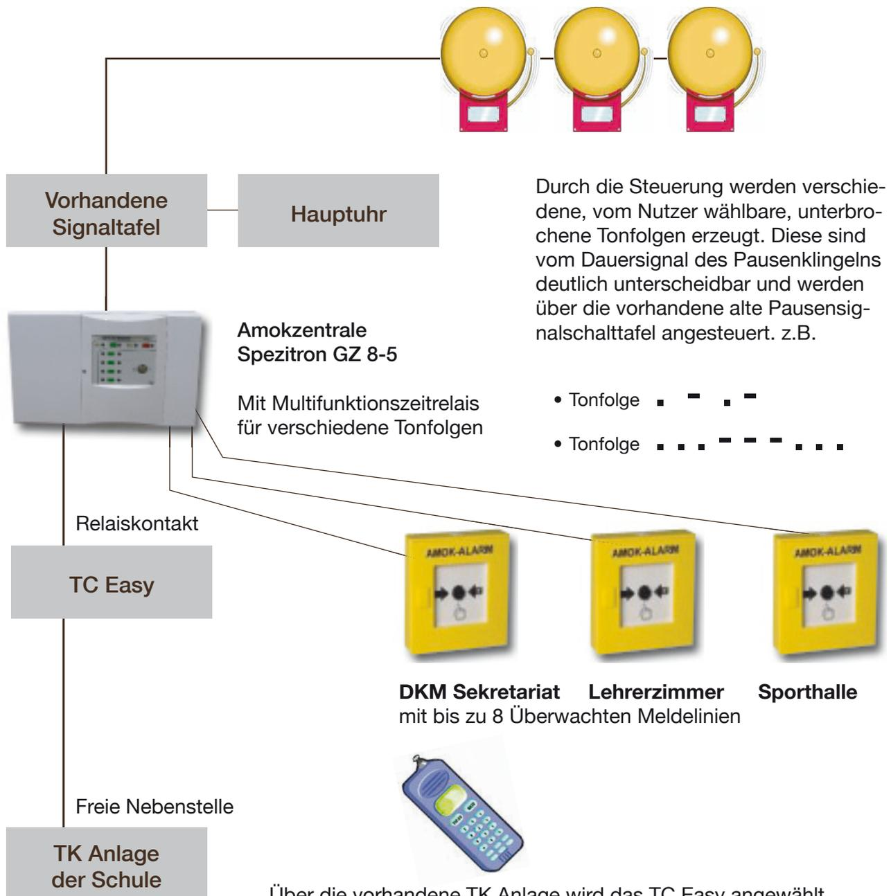
Über die vorhandene TK Anlage wird das TC Easy angewählt. Durch Eingabe eines 4 Stelligen Code wird die Amokanlage ausgelöst. Die Einwahl zum TC Easy ist sowohl von Außen übers Festnetz als auch übers interne Hausnetz gegeben.
