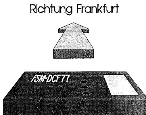
Eine genau mit der Längsachse senkrecht auf den Sender ausgerichtete Antenne(FSM) kann kein, oder nur noch ein schwaches Signal empfangen.
